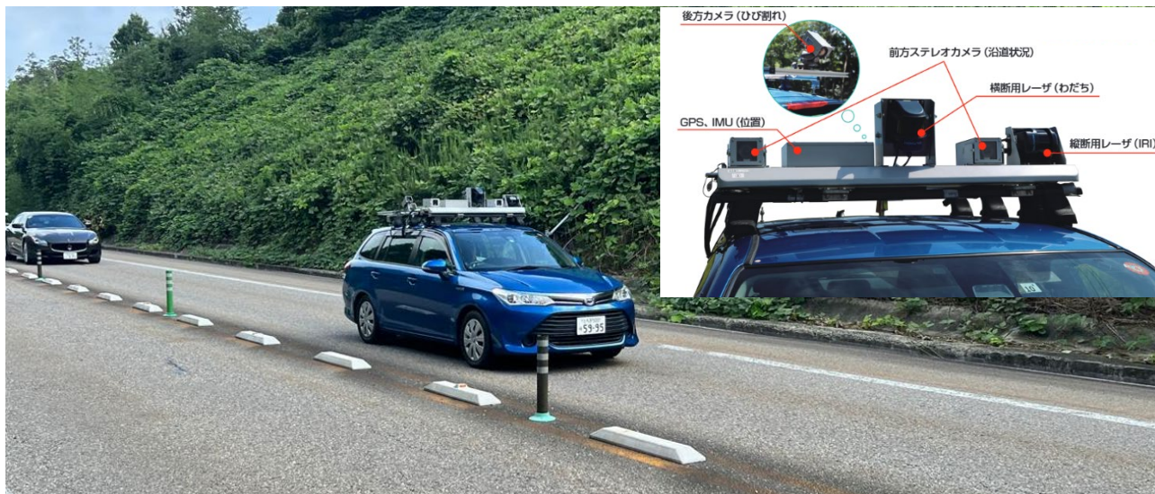
写真 1：路面性状測定車測定の様子
