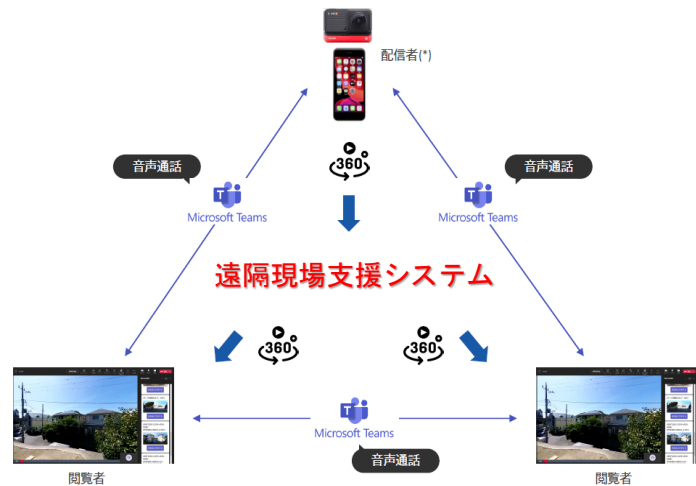
図 4 : 360 度カメラによる遠隔臨場の利用イメージ
