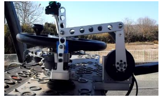
写真-2 AF 前後進レバー制御装置
