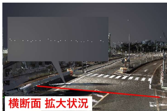
図-2 TLS で取得した点群
